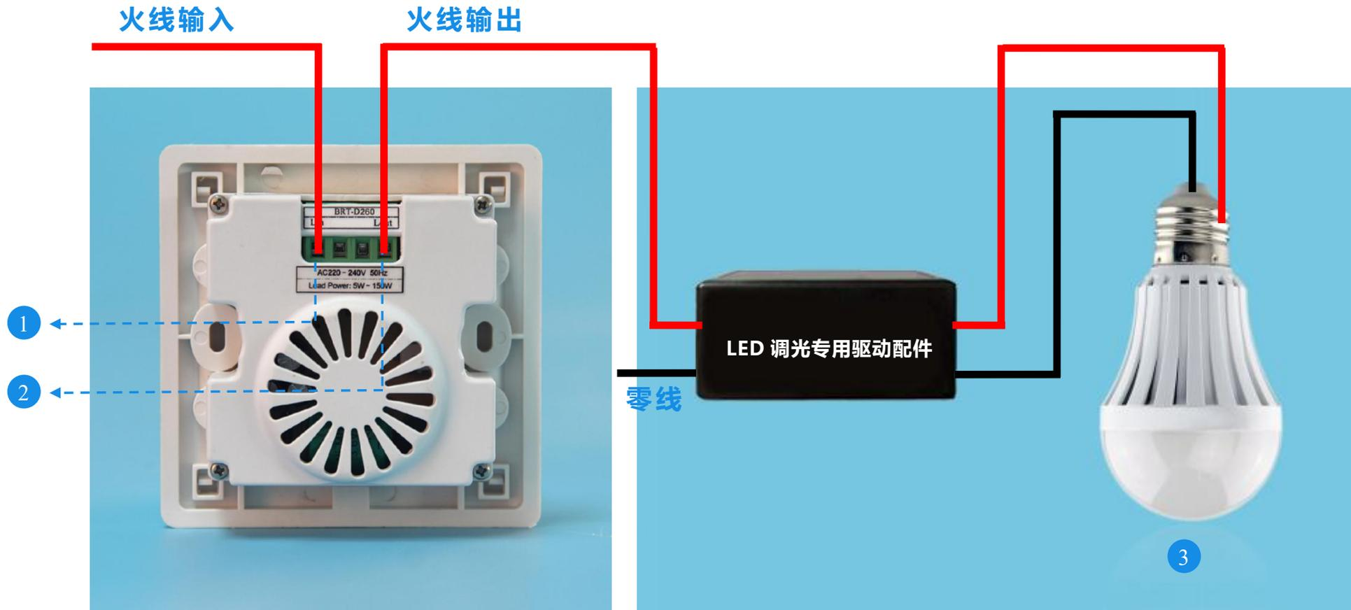
标注：① Lin: 火线输入接口    ② Lout: 火线输出接口    ③ 负载 (LED 灯泡)
