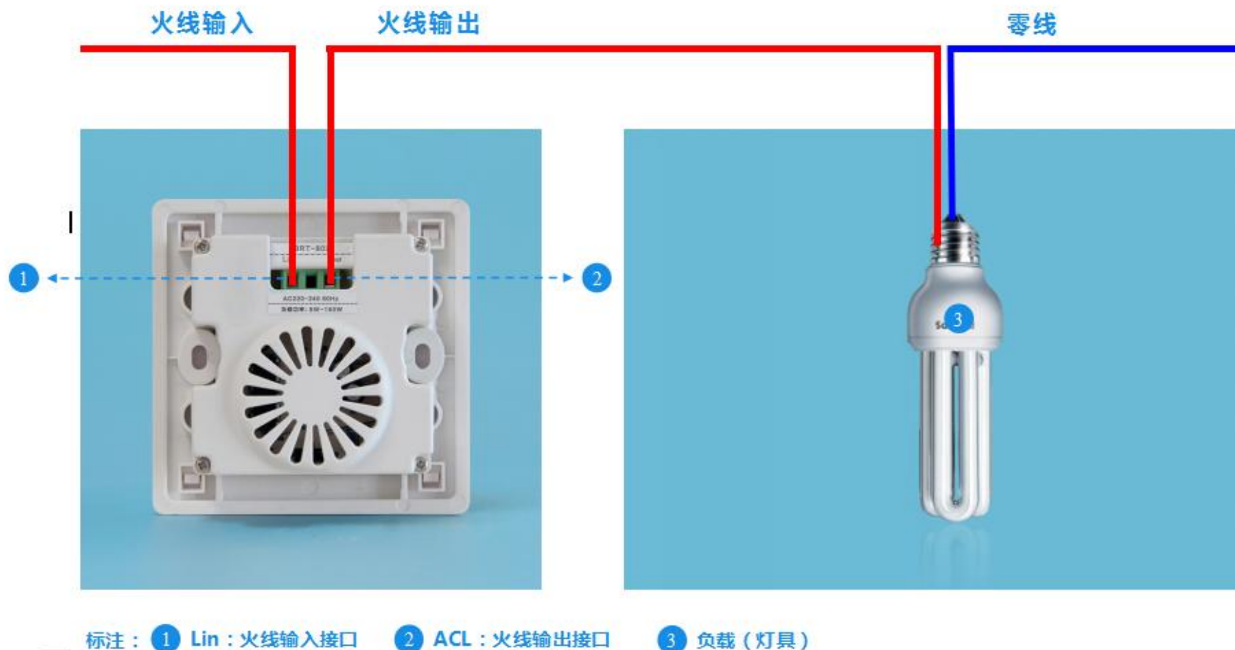
BRT-800/802 单火线接线图
