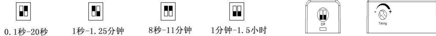
图六 延时关闭时间调节示意图
