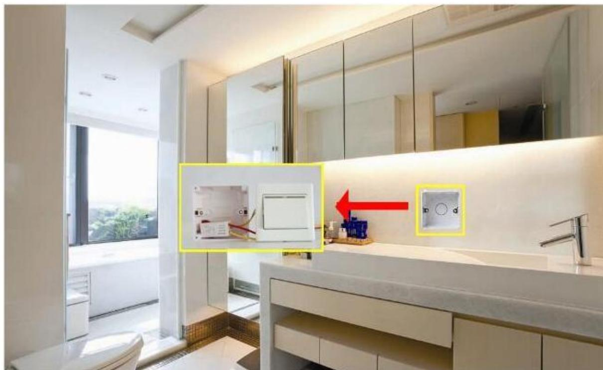
本开关体积微小，可方便的放入传统的 86 型机械开关内，无需更换原有的机械开关和增加布线，即可成为有延时调节功能的智能开关。
