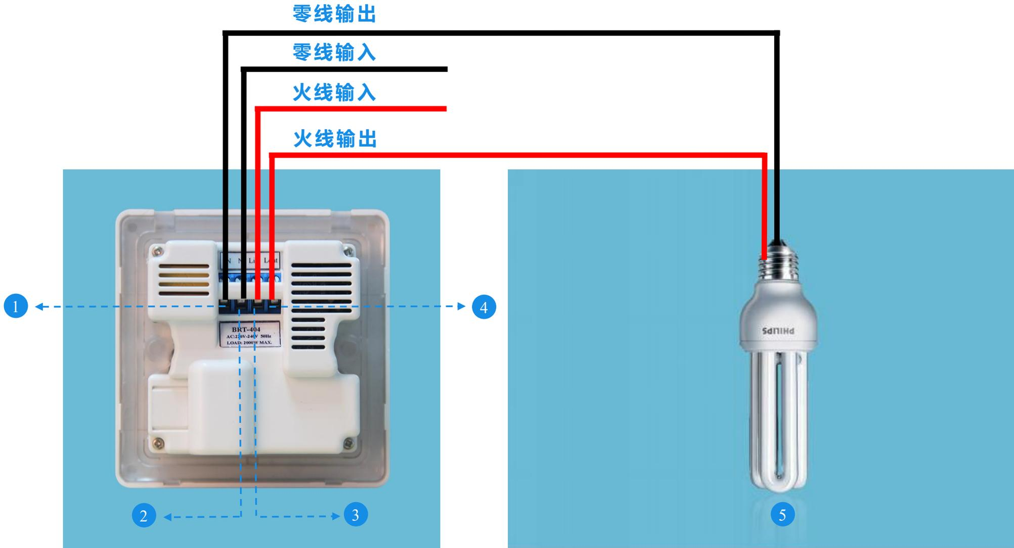
标注: ① N: 零线输出接口 ② N: 零线输入接口 ③ Lin: 火线输入接口 ④ Lout: 火线输出接口 ⑤ 负载 (灯具)
